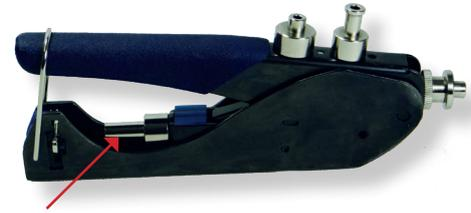
**! Hinweis:** Zum Verpressen der HW-KPHQ-Stecker ist der längste Kolbenaufsatz zu wählen.
