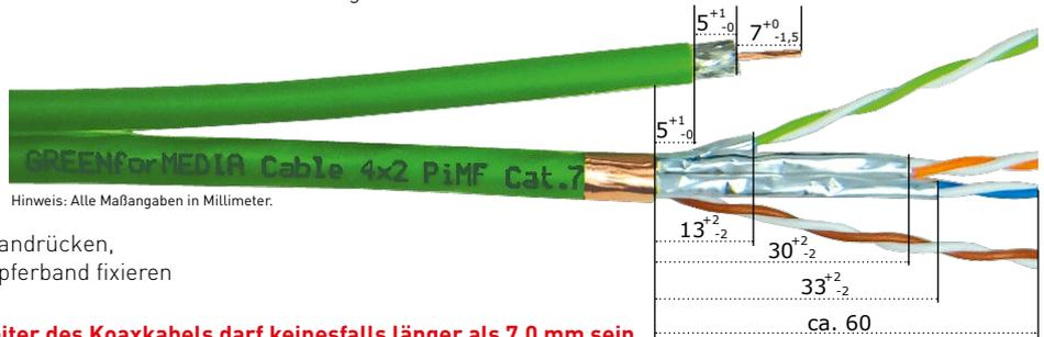
**Die Einhaltung der Absetzmaße ist wichtig. Der Innenleiter des Koaxialkabels darf keinesfalls länger als 7,0 mm sein.**
