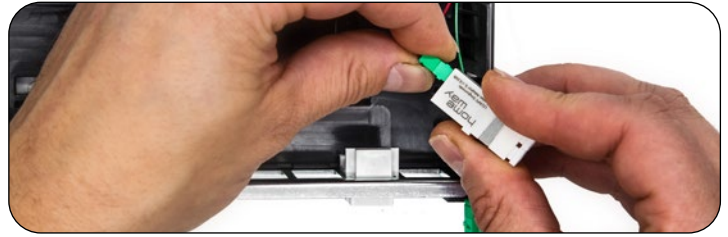
Abb. Den ersten LC/APC Stecker in die Kupplung einstecken Hinweis: Der Verriegelungshebel der LC/APC Stecker muss wie auf den Abbildungen nach unten ausgerichtet sein.
