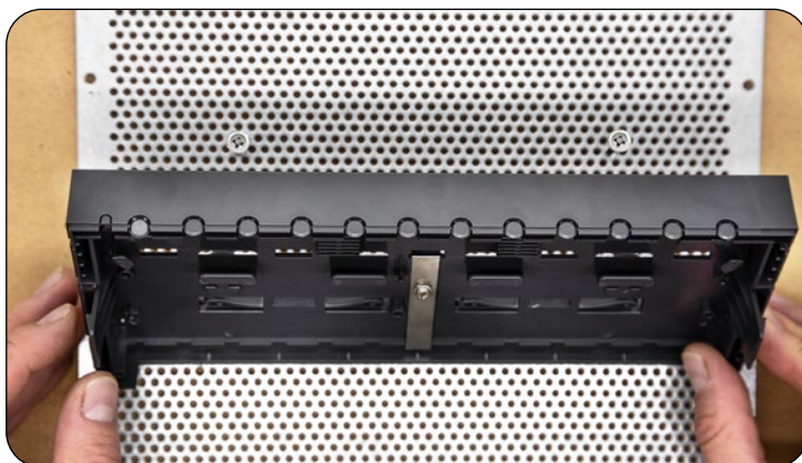
Abb. Vorbereitung Montage auf Gitterlochblech mit zwei Blechschrauben
