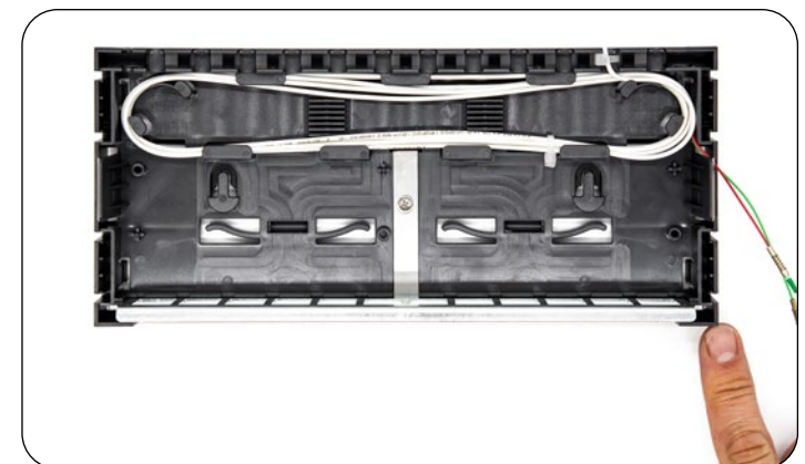
Abb. Glasfaseranschlüsse zunächst seitlich ablegen
