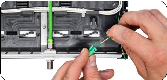
Abb. Glasfaseranschluss-Stecker (LC/APC) Steckergehäuse anbringen, dabei die metallische Planfläche nach links ausrichten. Während der Lösehebel des Steckergehäuses nach oben zeigt.
