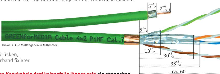
**Die Einhaltung der Absetzmaße ist wichtig. Der Innenleiter des Koaxkabels darf keinesfalls länger sein als angegeben, sonst wird die Kontaktfeder der homeway Dose beschädigt.**
