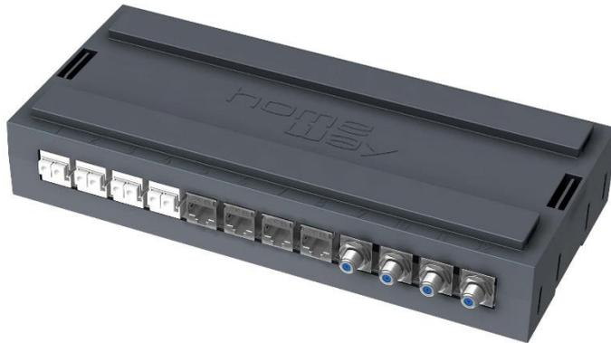
**BU:** Der homeBox NX 12 Verteilerfeldbox von homeway ist mit 12 Ports zur Aufnahme von Keystone-Modulen (LC Duplex, RJ45, Koax) ausgestattet. Glasfaser-, LAN- und Koaxialanschlüsse können an den 12 Ports beliebig kombiniert werden.
